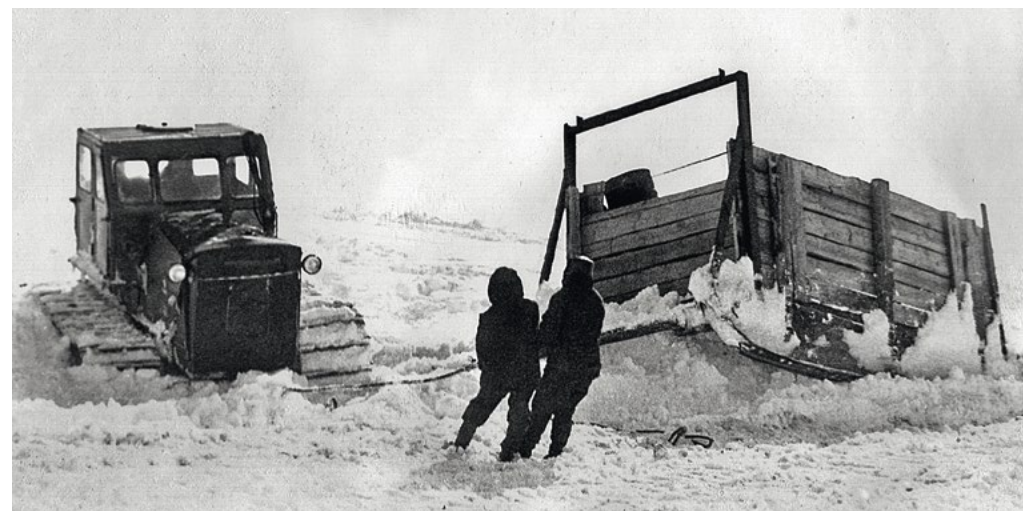
Фото 2. Пролив Чечекуиым. Трактор Т-100 (полуболотоход) «буксует» в наледи даже с пустыми санями
